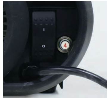
Funkensicherer Netzschalter, Stromkabel und Schutzschalter*
